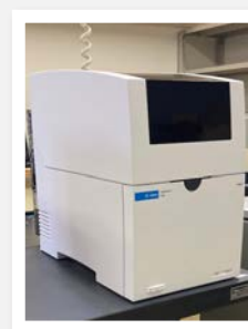
微量核酸電気泳動装置 Agilent Technologies社 4150 TapeStation
